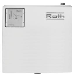
Vollautomatische elektronische Steuereinheit zur bedarfs- und DIN-gerechten Trinkwassernachspeisung direkt zur Pumpe, integrierte Füllstandsanzeige, Funktionsüberwachung mit Alarmfunktion, regelmäßiger Wasseraustausch, freier Auslauf nach DIN und voll recyclebar.
