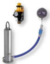
Komplettes Wasserversorgungspaket für Regenwassernutzungsanlagen: Unterwassermotorpumpe für vollständig oder teilweise eingetauchten Dauerbetrieb, Einbautiefe maximal 20 m, inklusive Schaltautomat KIT O2 und schwimmender Entnahme. Einsetzbar in Verbindung mit dem Roth Nachspeisemodul RON Komfort. Förderströme maximal 6 m<sup>3</sup>/h, Förderhöhe maximal 55 m, Einschaltdruck 2,4 bar, maximaler Anlagenenddruck 10 bar und maximale Anlagenhöhe 20 m.
