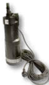
Mehrstufige, mediumgekühlte Tauchpumpe für Garten und Haus. Die Pumpe besitzt einen integrierten Druckflusswächter mit elektronischer Ein- und Ausschaltautomatik. Aufgrund des integrierten Durchflusswächters gewährleistet sie ein sicheres Abschalten im Trockenlauf, Fördermenge maximal 5,7 m<sup>3</sup>/h, Anlagenhöhe maximal 20 m, Anlagendruck maximal 3,6 bar und Eintauchtiefe maximal 8 m.
