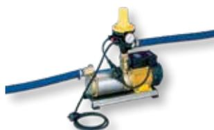
4-stufige horizontale Kreiselpumpe, selbstansaugend mit integriertem Trockenlaufschutz, Leistungsaufnahme 700 W, Förderhöhe maximal 42 m, Fördermenge 3,5 m<sup>3</sup>/h, Ansaughöhe 3 m, Saugleitungslänge 15 m, Lieferung inklusive Pumpenanschluss-Set und Pumpenkonzole.
