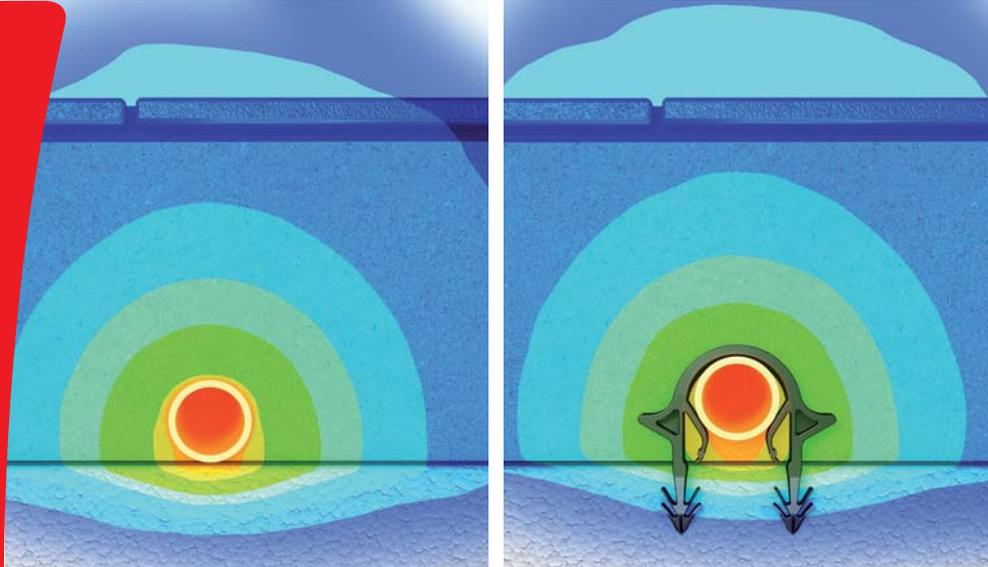
Durch die Rohranhebefunktion kann der Estrich unter das Rohr fließen, sodass er es vollständig umgibt. Dies sorgt für eine ideale Übertragung und Verteilung der Wärme und Kühlung und damit für das Plus an Effizienz und Komfort.
