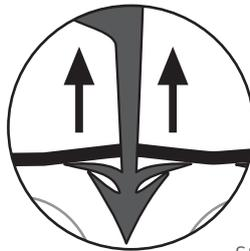
Der untere Widerhaken des Roth Original-Tacker® E<sup>x</sup>-Klips ist hochstabil und zusätzlich mit einer scharfen Schneidekante versehen, während der darüber liegende Widerhaken besonders elastisch ist. Diese spezielle Technologie sorgt für ein leichtes und sicheres Eindringen durch die Dämmfolie in die Dämmung und optimiert damit die Montagefreundlichkeit und -schnelligkeit. Die Stabilität des unteren Widerhakens bietet eine ideale Stützfunktion für den oberen Widerhaken.
