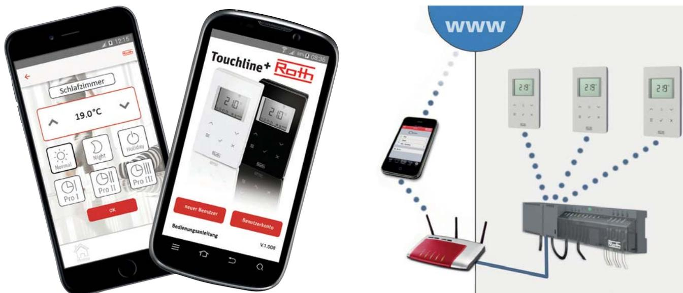
■ Mit der Touchline+ App können Sie Ihre Roth EnergyLogic Touchline Funk-Regelung zu Hause über WLAN oder unterwegs über den Roth-Portal-Server im Internet steuern. Einfach das Touchline Anschlussmodul über RJ45 mit dem bestehenden Heimnetzwerk verbinden. Die Verwendung eines WLAN-Routers ist für das erstmalige Einrichten notwendig.
